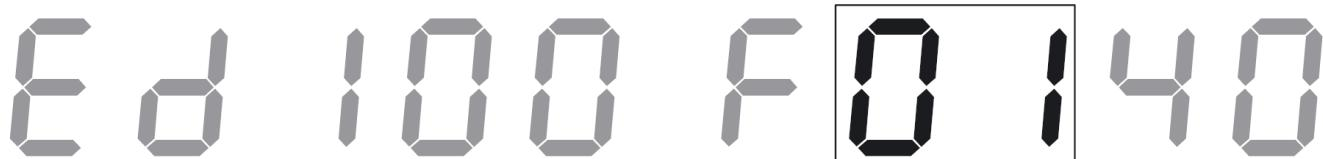
На дисплее бегущей строкой отображается обозначение устройства: ED 100 или ED 250 и название модели. (На примере сверху показано устройство ED 100, модель F 01 40)
